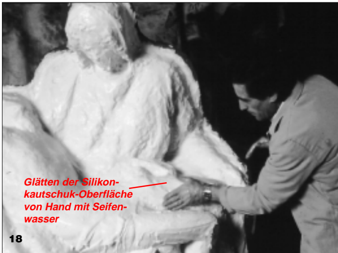
Trennwulst aus Ton Feinschicht aus ELASTOSIL® M 4503
